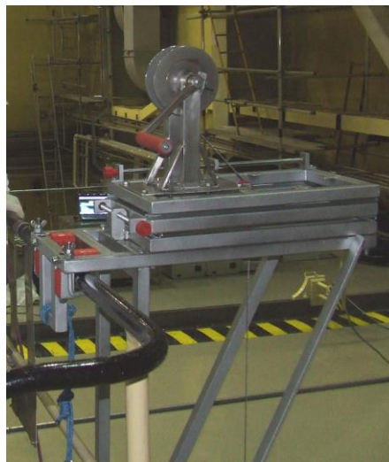
A hordozható kiégett fűtőelem attribútum tesztet felfüggesztő-pozícionáló asztala, felszerelve az átrakógép korlátjára
